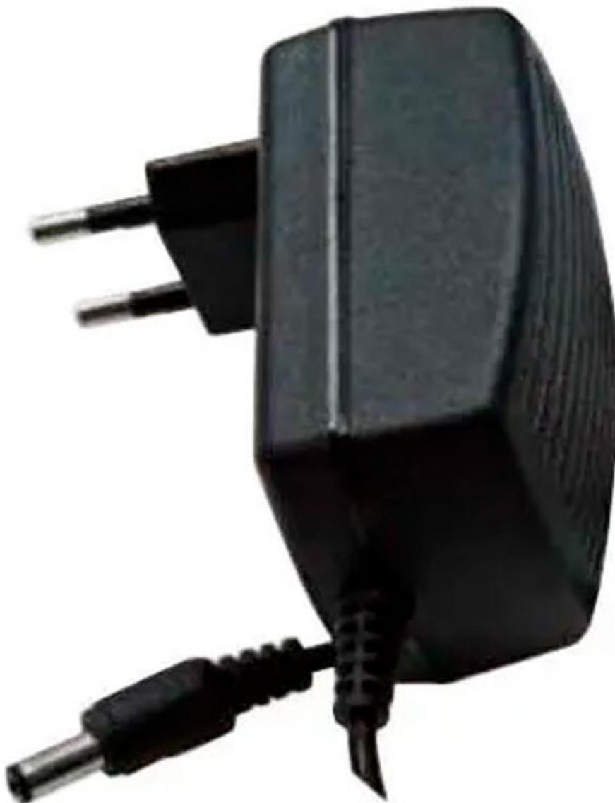
Alimentatore switching con tensione di uscita 12 VDC in grado di erogare una corrente di 1000 mA. Dispone di plug da 2,1x5,5 mm con cavo lungo 1 metro.
