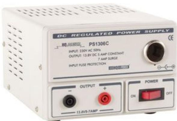
Alimentatore stabilizzato da banco con uscita singola di 13,8 Vdc in grado di erogare una corrente massima di 6 A (7 A di picco) dispone anche di una uscita con presa accendisigari. Il circuito di alimentazione a 220 Vac è protetto tramite fusibile mentre l'uscita dispone di protezione da cortocircuiti. Contenitore in acciaio. Colore: bianco/grigio.
