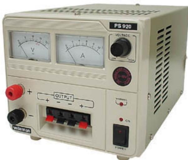
Alimentatore stabilizzato da laboratorio con un'uscita regolabile da 3 a 15 Vdc/20 A e due uscite regolabili da 3-15 Vdc/2,5 A (le uscite non sono indipendenti). Protezione da cortocircuiti e Led di segnalazione di sovraccarico. Amperometro e voltmetro di tipo analogico.
