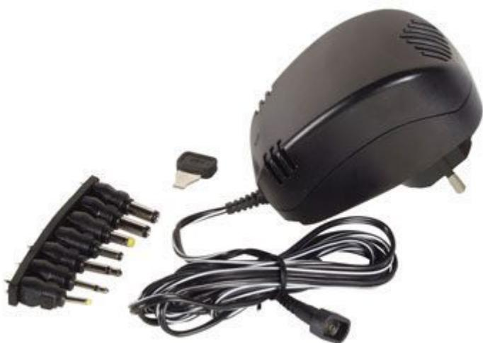
Alimentatore 500 mA non stabilizzato. Potenza 11 W. Tensioni di uscita: 3 - 4,5 - 6 - 7,5 - 9 - 12 V. Possibilità di selezione della polarità. Completo di 7 connettori a plug intercambiabili. Spina di tipo SHUKO.
