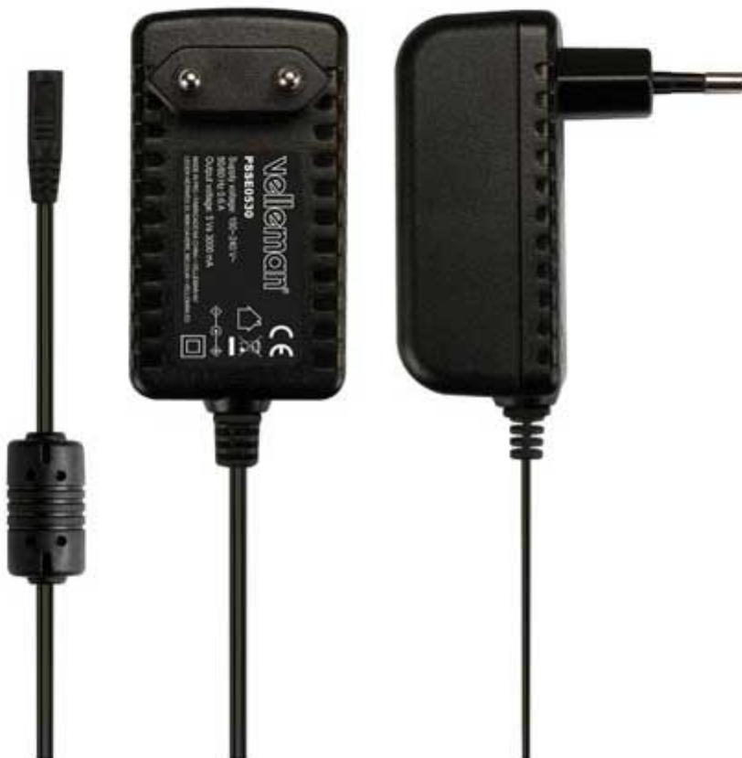
Alimentatore switching stabilizzato da 15VA in grado di erogare 3000 mA con tensione d'uscita di 5 volt. Dispone di protezione sia da eventuali corto circuiti in uscita che da sovratemperatura. Completo di 5 diversi plug di uscita intercambiabili.
