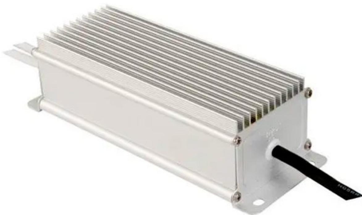
Alimentatore per LED dotato di protezione contro i cortocircuiti, i sovraccarichi e le sovratensioni (255 V). Il grado di protezione IP67 lo rende adatto per essere impiegato all'esterno. Protezione termica di 80°.
