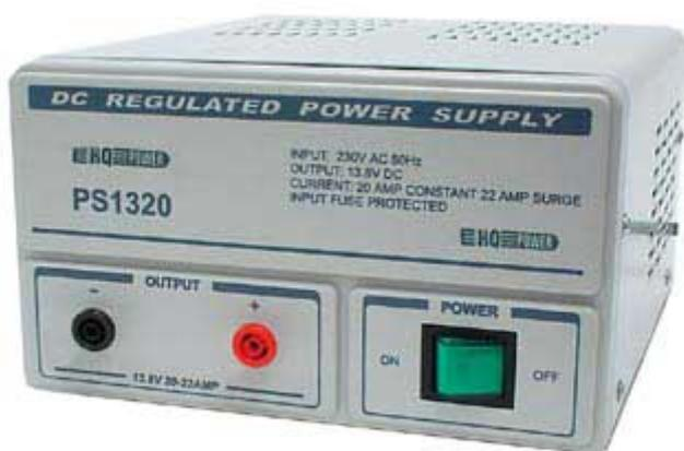
Alimentatore stabilizzato da banco con uscita singola di 13,8 Vdc in grado di erogare una corrente massima di 20 A (22 A di picco). Il circuito di alimentazione a 220 Vac è protetto tramite fusibile mentre l'uscita dispone di protezione da cortocircuiti. Contenitore in acciaio. Colore: bianco/grigio.
