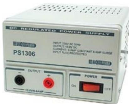
Alimentatore stabilizzato da banco con uscita singola di 13,8 Vdc in grado di erogare una corrente massima di 6 A (8 A di picco). Il circuito di alimentazione a 220 Vac è protetto tramite fusibile mentre l'uscita dispone di protezione da cortocircuiti. Contenitore in acciaio. Colore: bianco/grigio.
