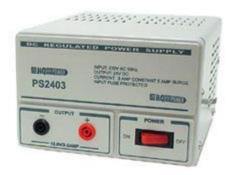
Alimentatore stabilizzato da banco con uscita singola di 24 Vdc in grado di erogare una corrente massima di 3 A (5 A di picco). Il circuito di alimentazione a 220 Vac è protetto tramite fusibile mentre l'uscita è protetta da limitatore di corrente. Contenitore in acciaio. Colore: bianco/grigio.
