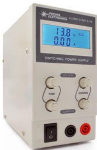
Alimentatore switching da laboratorio con tensione di uscita regolabile da 0 a 30 Vdc e corrente massima di 3 A. Il display LCD con retroilluminazione indica la tensione e la corrente erogata dall'alimentatore. Contenitore in acciaio, pannello frontale in plastica. Completo di cavo di alimentazione da rete e cavi con spina a banana.
