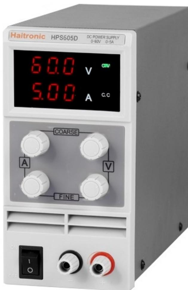
Alimentatore switching da laboratorio con tensione di uscita regolabile da 0 a 60 VDC e corrente massima di 5 A. Il display a Led indica la tensione e la corrente erogata dall'alimentatore. Doppia regolazione tensione/corrente ( fine e grossolana ) e segnalazione di overload. Contenitore in metallo, pannello frontale in plastica. Completo di cavo alimentazione da rete e cavetti con coccodrillo da un lato e capocorda a forcina dall'altro.
