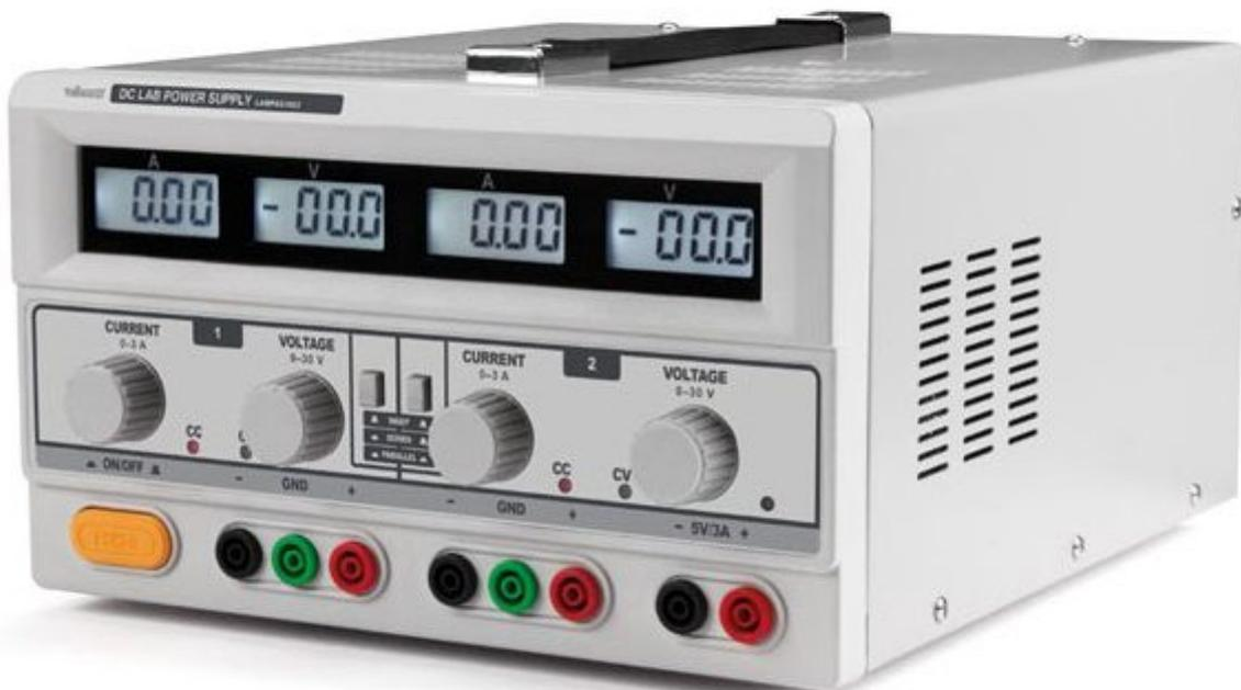
Alimentatore lineare da laboratorio dotato di doppia uscita regolabile in tensione e corrente (da 0 a 30 Vdc / da 0 a 3 A) e uscita fissa a 5 Vdc / 3 A. Dispone di display LCD retroilluminato per visualizzare la tensione e la corrente, regolazioni di tensione e corrente normale e fine, modalità di protezione: limitazione di corrente, connettori di uscita: IEC1010, protezione di rete: fusibile. Colore: bianco-grigio.
