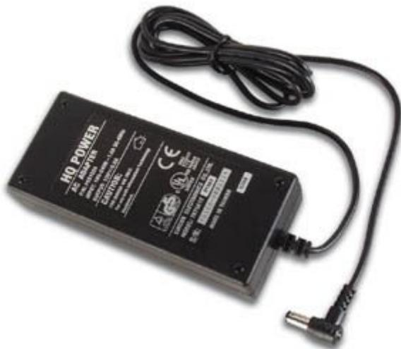
Alimentatore switching da rete da 70 watt in grado di fornire una tensione di 12 Vdc stabilizzata con una corrente massima di 5,5A. Tensione di ingresso universale 90-260 Vca, protezione contro i corto circuiti di uscita.
