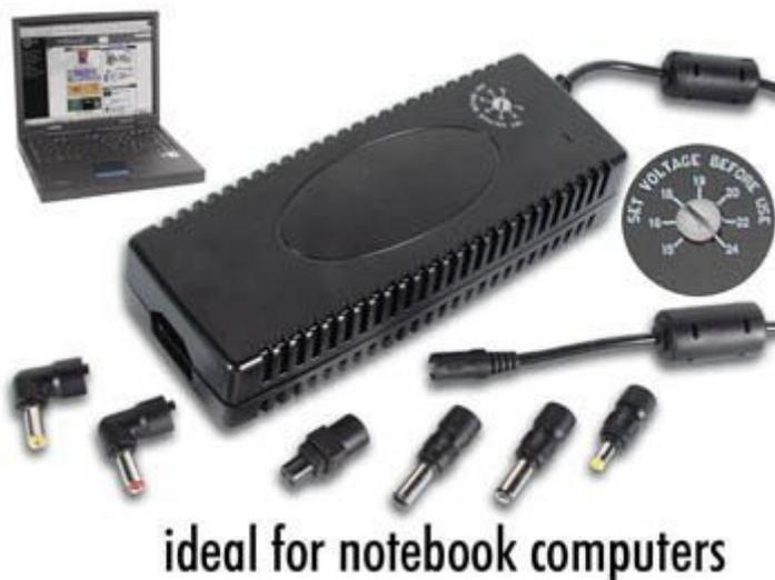
Adattatore switching in grado di alimentare qualsiasi computer portatile. Grazie alla possibilità di scegliere tra sette differenti tensioni di uscita ed alla disponibilità di connettori di varie misure, questo dispositivo può sostituire qualsiasi alimentatore originale. Elevata stabilità della tensione di uscita e protezione da i sovraccarichi ed i cortocircuiti di uscita. Led di accensione.
