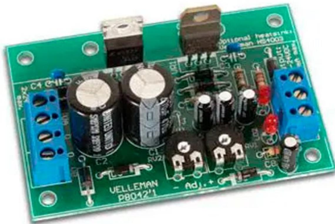
Economico alimentatore duale per impieghi generali. Per funzionare necessita del trasformatore di alimentazione e del dissipatore. Ideale per alimentare amplificatori operazionali e dispositivi similari. I trimmer possono essere sostituiti da potenziometri per una regolazione continua della tensione di uscita. Dimensioni particolarmente compatte, led di uscita.
