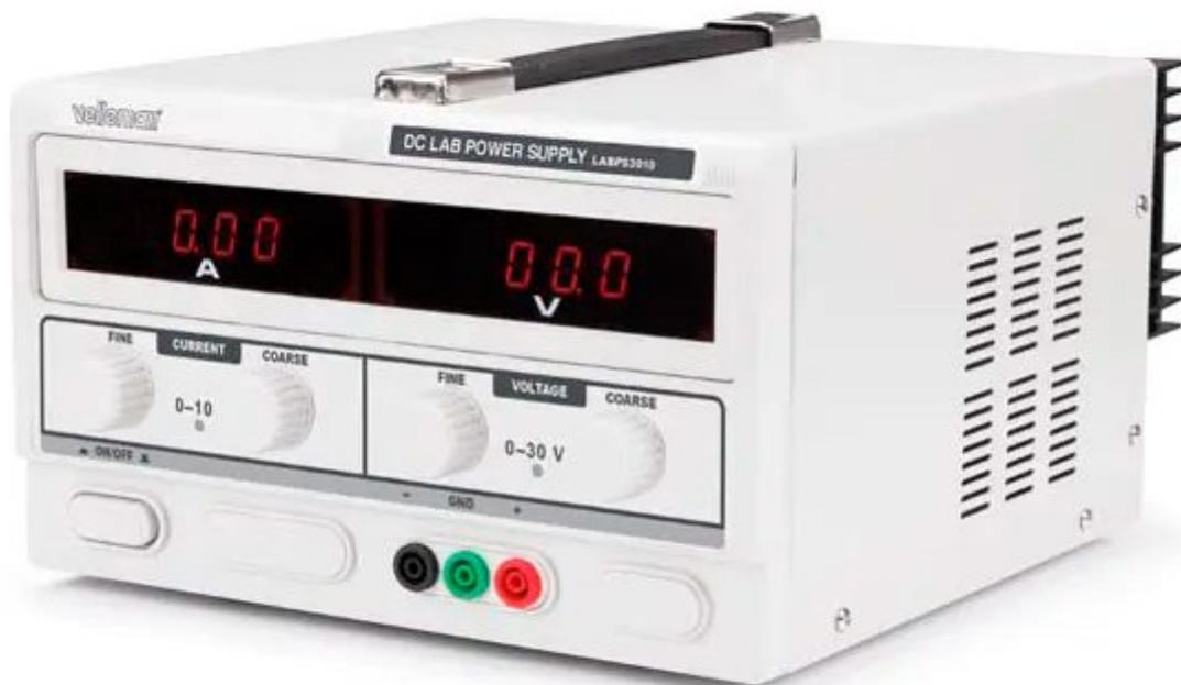
Alimentatore lineare da laboratorio con tensione di uscita regolabile da **0 a 30 Vdc** e corrente massima di **10 A**. Dispone di doppio display a LED per visualizzare la tensione e la corrente, regolazioni di tensione e corrente normale e fine, modalità di protezione: limitazione di corrente, connettori di uscita: IEC1010, protezione di rete: fusibile. Colore: bianco-grigio.
