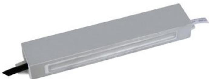
Il grado di protezione IP67 lo rende adatto per essere impiegato all'esterno. È dotato di protezione contro i cortocircuiti, i sovraccarichi, e le sovratensioni (255 V). Protezione termica di 80°.
