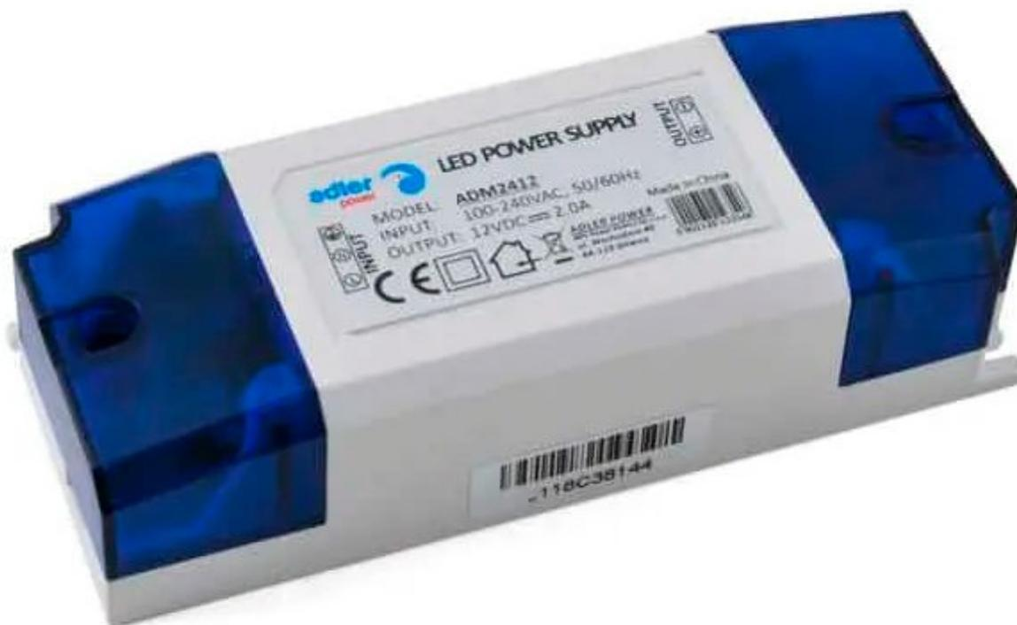
Alimentatore per LED con tensione di uscita 12V e corrente di 2A. Dispone di protezione contro cortocircuiti, sovraccarico e sovracorrente. Alimentazione: 110-264 VAC 50/60 Hz. Non richiede alcun dissipatore di calore. Solo per utilizzo all'interno. Dimensioni 115x44x28mm, peso 100 grammi.
