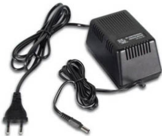
Alimentatore stabilizzato in grado di erogare una corrente massima di 1 A. Caratteristiche: tensione in uscita: 12 Vdc, tensione d'ingresso: 230 Vac / 50 Hz, corrente in uscita: 1 A, dimensioni: 122 x 76 x 60 mm, plug: 5,5 x 2,1 mm.
