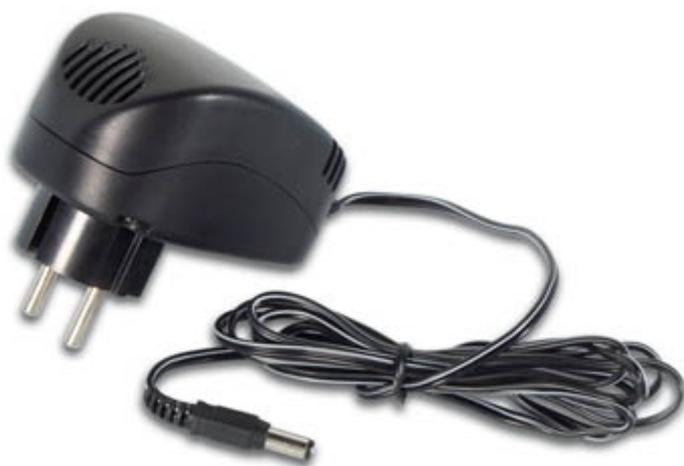
Alimentatore stabilizzato 500mA. Caratteristiche: tensione d'uscita: 12Vdc, corrente massima in uscita: 500mA, dimensioni plug: 5,5 x 2,1 mm, ingresso: 230Vac / 50Hz, dimensioni: 92 x 56 x 84mm.
