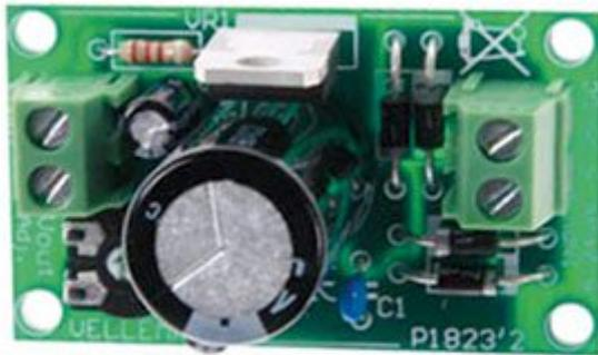
Modulo di alimentazione (montato) in grado di erogare una corrente massima di 1 A, uscita regolabile da un minimo di 1,5 VDC ad un massimo di 30 VDC, accetta in ingresso tensioni da 5 a 24 VAC oppure 35 VDC. Dimensioni molto compatte solo 52 x 30 x 35 mm. E' consigliato l'utilizzo di un dissipatore.
