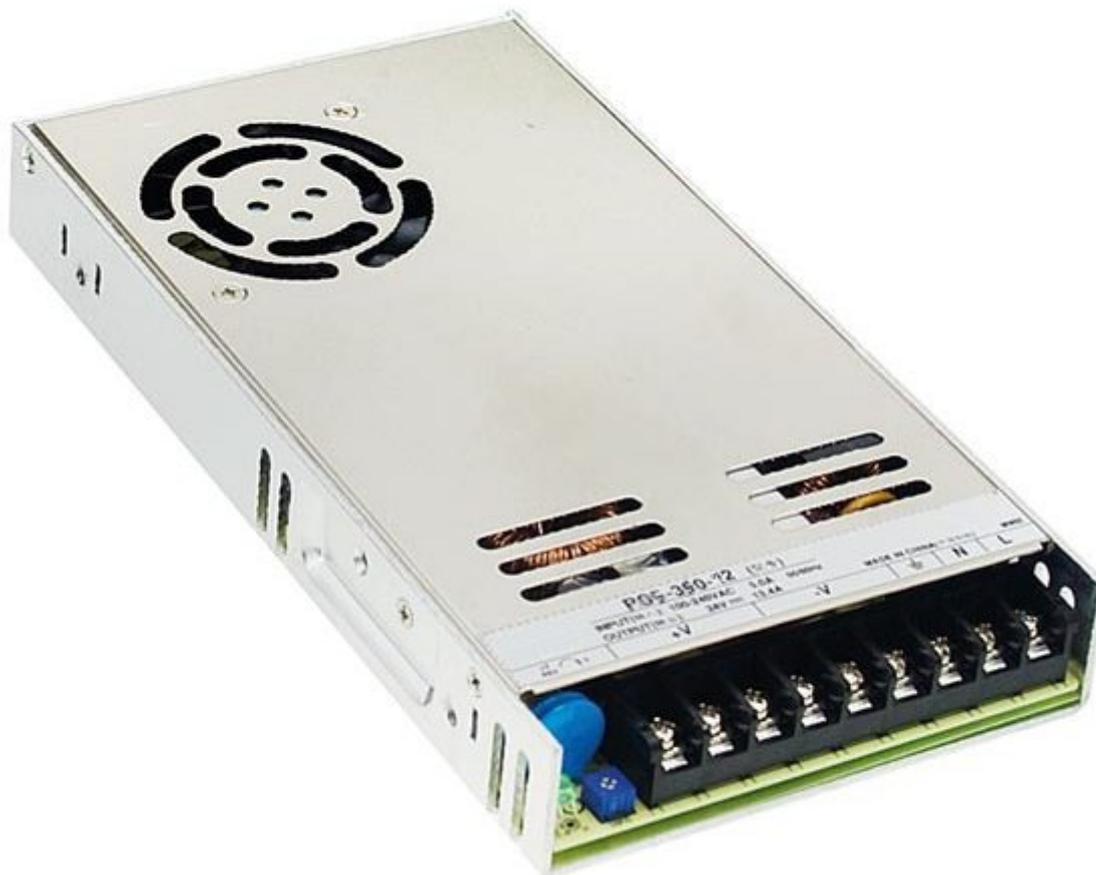
Alimentatore da laboratorio in tecnologia switching ad alta efficienza. Contenitore in metallo, con ventola di raffreddamento, tensione d'ingresso: 100/120 Vac o 200/240 Vac, tensione di uscita 12 volt, corrente 29 A, potenza 348 W. Dispone di LED indicatore di alimentazione, protezione da cortocircuito, sovraccarico, sovratensione e sovratemperatura. La tecnologia switching consente di ottenere una notevole riduzione del peso ed un elevatissimo rendimento energetico del dispositivo.
