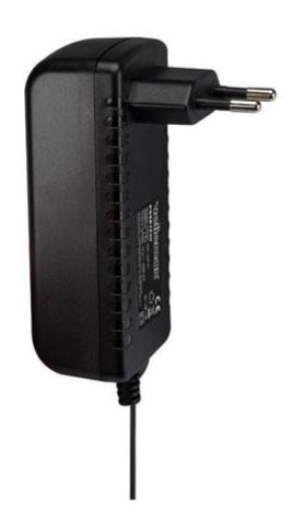
Alimentatore switching ultra compatto con uscita stabilizzata a 12 V - 3 A plug DC (positivo centrale). Protetto da cortocircuito e sovraccarico, dispone di basso ripple e rumore, alta efficienza e basso consumo di energia in assenza di carico.
