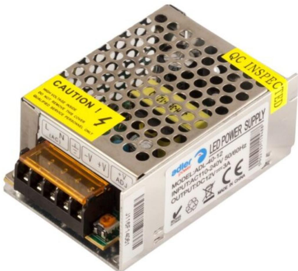
Alimentatore switching con tensione d'uscita costante di 12V, corrente 3A e potenza 36W. Contenitore in metallo, è caratterizzato da dimensioni compatte e peso ridotto che ne consente l'installazione anche in spazi ristretti. Queste caratteristiche lo rendono particolarmente indicato per essere impiegato per alimentare gli strip a LED. Dimensioni 85x58x37mm, peso 90g.
