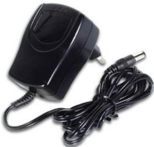
Compatto adattatore da rete di tipo switching in grado di erogare una tensione di 12 volt stabilizzati con una corrente massima di 1,7A. Connettore con positivo centrale 2,1 x 5,5 mm, protezione contro i corto circuiti di uscita ed i sovraccarichi.
