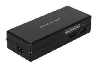
Compatto alimentatore switching da 120 W con uscita USB 5 V / 500 mA e sette tensioni di uscita selezionabili da 15 a 24 Vdc. Dispone di protezione da corto circuiti in uscita e da sovraccarico. Uscita stabilizzata e basso ripple. Alta efficienza e basso consumo energetico. Completo di 8 diversi plug di uscita intercambiabili. Ideale per computer portatili e dispositivi elettronici digitali.
