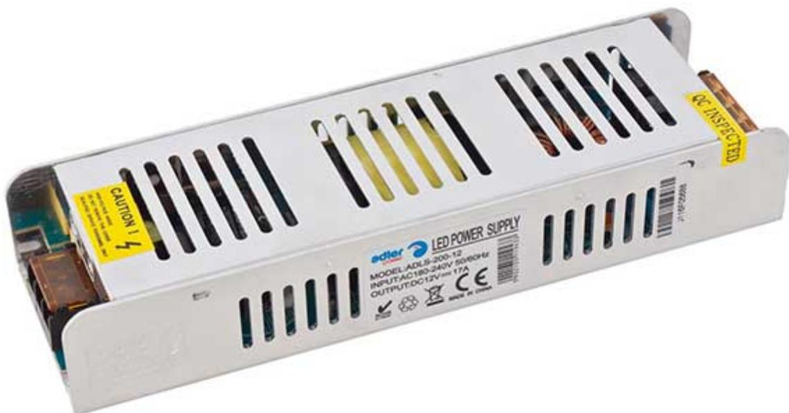
Alimentatore switching con tensione d'uscita costante di 24V, corrente 8.33A e potenza 200W. Contenitore in metallo, è caratterizzato da dimensioni compatte e peso ridotto che ne consente l'installazione anche in spazi ristretti. Queste caratteristiche lo rendono particolarmente indicato per essere impiegato per alimentare gli strip a LED. Dimensioni 223x68x40mm, peso 500g.
