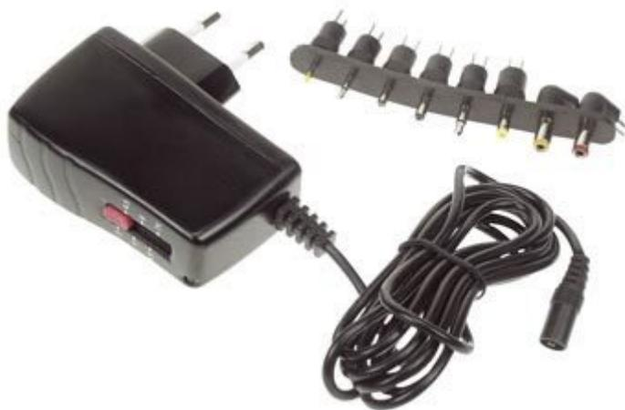
Alimentatore switching stabilizzato da 13VA in grado di erogare 1900 mA alle tensioni di 3 - 4,5 - 5 - 6 - 6,5 - 7 volt. Dispone di protezione sia da eventuali corto circuiti in uscita che da sovratemperatura. Completo di 8 diversi plug di uscita intercambiabili.
