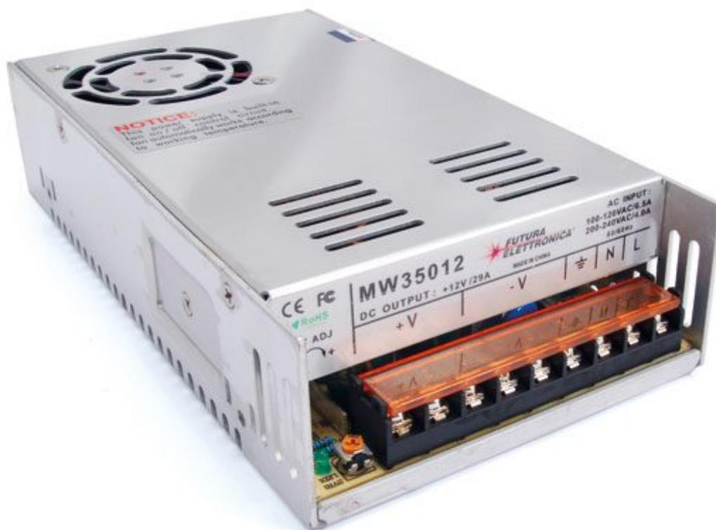
Alimentatore da laboratorio in tecnologia switching ad alta efficienza, lunga durata ed elevata affidabilità. Contenitore in metallo, sistema di raffreddamento a ventola, tensione d'ingresso: da 90 a 264 VAC, tensione di uscita 12 volt, corrente 29 A, potenza 348 W. Dispone di LED indicatore di alimentazione, protezione da cortocircuito e sovraccarico. La tecnologia switching consente di ottenere una notevole riduzione del peso ed un elevatissimo rendimento energetico del dispositivo.
