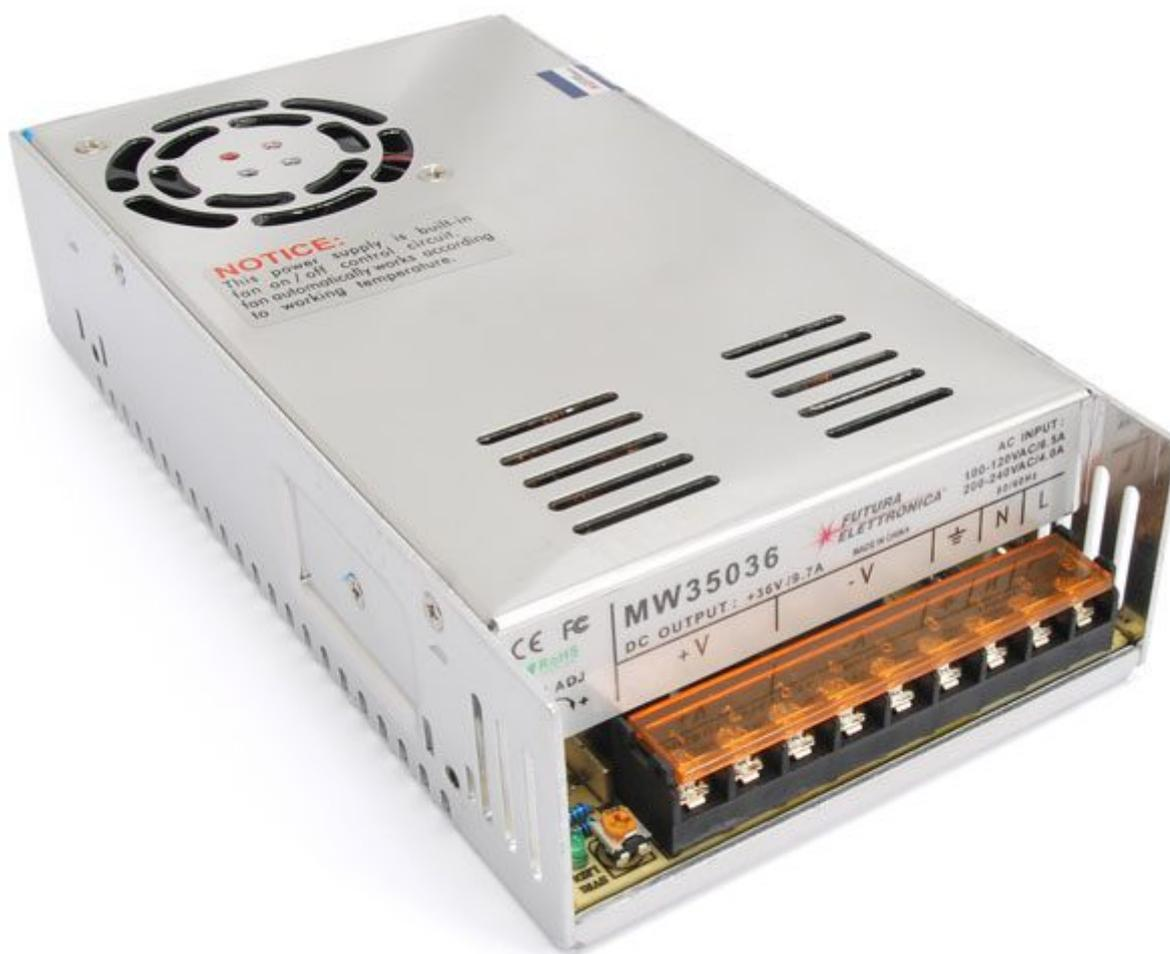
Alimentatore da laboratorio in tecnologia switching ad alta efficienza, lunga durata ed elevata affidabilità. Contenitore in metallo, sistema di raffreddamento a ventola, tensione d'ingresso: da 90 a 264 VAC, tensione di uscita 36 volt, corrente 9,7 A, potenza 349,2 W. Dispone di LED indicatore di alimentazione, protezione da cortocircuito e sovraccarico. La tecnologia switching consente di ottenere una notevole riduzione del peso ed un elevatissimo rendimento energetico del dispositivo.
