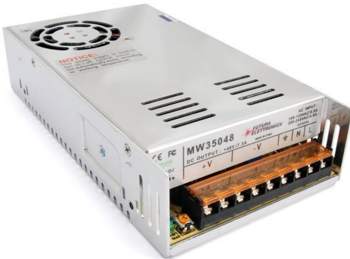
Alimentatore da laboratorio in tecnologia switching ad alta efficienza, lunga durata ed elevata affidabilità. Contenitore in metallo, sistema di raffreddamento a ventola, tensione d'ingresso: da 90 a 264 VAC, tensione di uscita 48 volt, corrente 7,3 A, potenza 350,4 W. Dispone di LED indicatore di alimentazione, protezione da cortocircuito e sovraccarico. La tecnologia switching consente di ottenere una notevole riduzione del peso ed un elevatissimo rendimento energetico del dispositivo.
