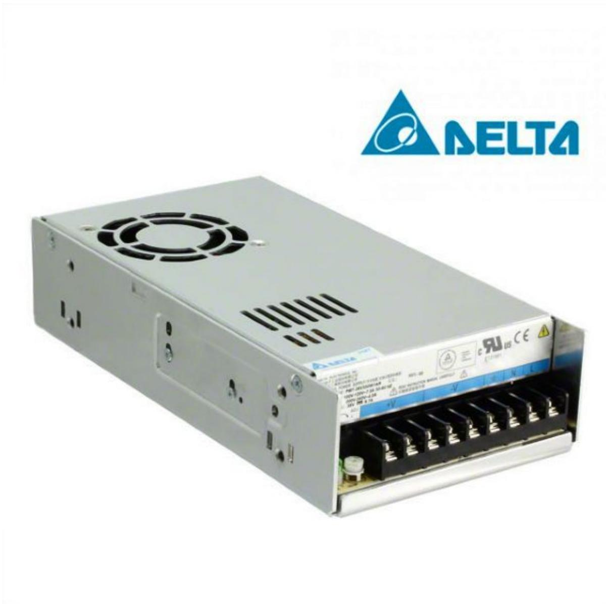
Alimentatore da laboratorio in tecnologia switching ad alta efficienza, lunga durata ed elevata affidabilità. Contenitore in metallo, sistema di raffreddamento a ventola, tensione d'ingresso: da 90 a 264 VAC, tensione di uscita 48 volt, corrente 7,3 A, potenza 350 W. Dispone di LED indicatore di alimentazione, protezione da cortocircuito e sovraccarico. La tecnologia switching consente di ottenere una notevole riduzione del peso ed un elevatissimo rendimento energetico del dispositivo.
