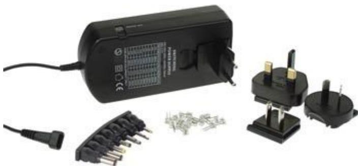
Viene fornito con 20 resistenze per l'impostazione della tensione d'uscita (da 5V a 24V), 4 differenti spine di rete intercambiabili e 7 tipi di spine DC per l'uscita.
