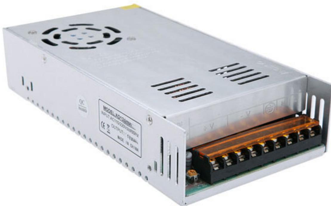
Alimentatore da laboratorio in tecnologia switching ad alta efficienza, lunga durata ed elevata affidabilità. Contenitore in metallo, sistema di raffreddamento a ventola, tensione d'ingresso: da 110 a 220 VAC, tensione di uscita 48 volt, corrente 10 A, potenza 480 W. Dispone di LED indicatore di alimentazione, protezione da cortocircuito e sovraccarico. La tecnologia switching consente di ottenere una notevole riduzione del peso ed un elevatissimo rendimento energetico del dispositivo.
