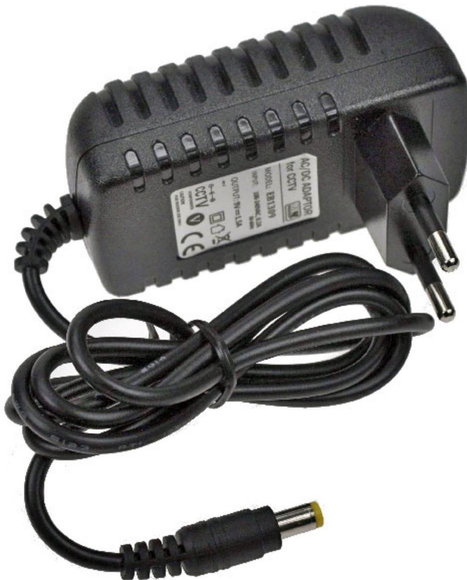
Alimentatore switching ultra compatto (46,5x45,9x27,2 mm) con uscita 5 V - 2 A connettore plug DC. Protetto da cortocircuito e con un basso consumo di energia in assenza di carico. Progettato per una vasta gamma di dispositivi.
