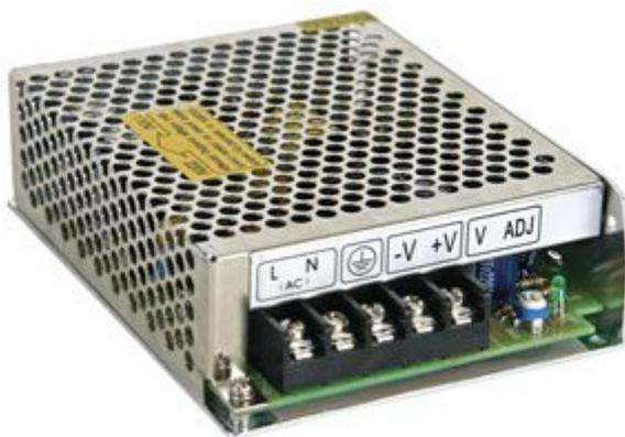
Alimentatore da laboratorio in tecnologia switching. Tensione di uscita 5 volt, corrente 8 A, potenza 40 W. La tecnologia switching consente di ottenere una notevole riduzione del peso ed un elevatissimo rendimento energetico del dispositivo.
