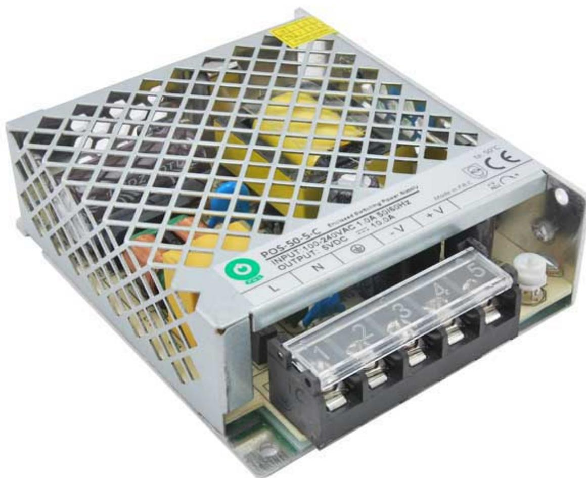
Alimentatore da laboratorio in tecnologia switching ad alta efficienza, lunga durata ed elevata affidabilità. Contenitore in metallo, sistema di raffreddamento a convezione naturale, tensione d'ingresso: da 100 a 240 VAC, tensione di uscita 5 volt, corrente 10 A, potenza 50 W. Dispone di LED indicatore di alimentazione, protezione da cortocircuito e sovraccarico. La tecnologia switching consente di ottenere una notevole riduzione del peso ed un elevatissimo rendimento energetico del dispositivo.
