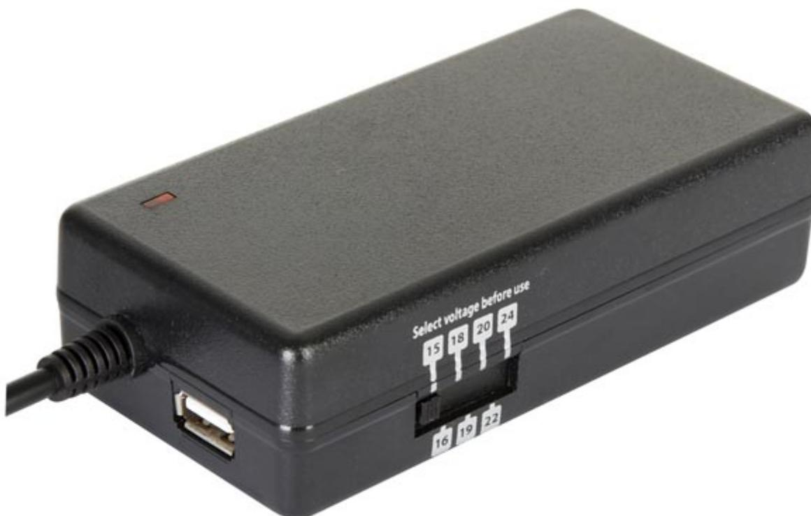
Compatto alimentatore switching da 70 W con uscita USB 5 V / 500 mA e sette tensioni di uscita selezionabili da 15 a 24 Vdc. Dispone di protezione da corto circuiti in uscita e da sovraccarico. Uscita stabilizzata e basso ripple. Alta efficienza e basso consumo energetico. Completo di 8 diversi plug di uscita intercambiabili. Ideale per computer portatili e dispositivi elettronici digitali.
