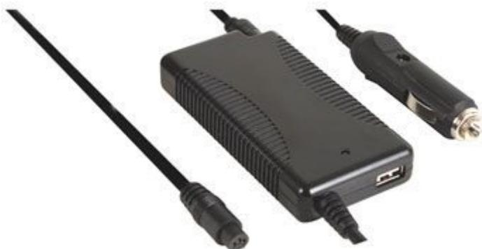
Alimentatore switching in grado di alimentare la maggior parte di computer portatili e altri dispositivi elettronici. Tensione d'ingresso 12÷24 Vdc, tensione d'uscita definita automaticamente dalla spina utilizzata: 15, 16, 19 Vdc, corrente massima erogabile 4,73 A, uscita USB 5 V / 1 A. Dispone di fusibile sulla linea di ingresso, protezione termica, contro i cortocircuiti ed i sovraccarichi. Completo di varie spine DC intercambiabili.
