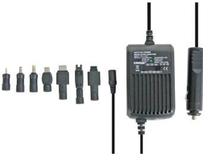
Consente di alimentare con i 12 volt disponibili in automobile la maggior parte dei PC portatili (max. 100 W) nonché numerose altre apparecchiature elettroniche. Fusibile di protezione sulla linea di ingresso, protezione in uscita in temperatura, contro i corto circuiti ed i sovraccarichi. Presa accendino. Spia di funzionamento a led.
