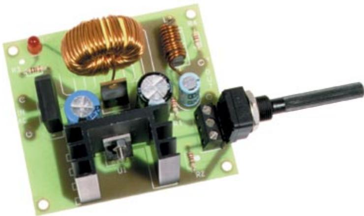
Alimentatore che impiega l'integrato LM2576 in versione ADJ per regolare la tensione raddrizzata e livellata prelevata da un trasformatore con primario da rete. Erega fino ad un massimo di 5 ampère, ha un rendimento molto elevato (circa 88%) ed è adatto ad alimentare carichi in corrente continua da 1,5 a 15 volt. La scatola di montaggio comprende tutti i componenti, l'integrato LM2576ADJ e un dissipatore. Non è compreso nel kit il trasformatore toroidale da 80VA 220/15V.
