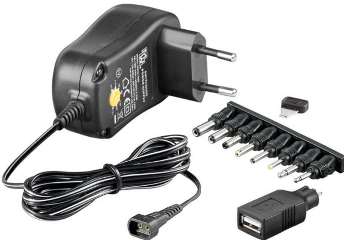
Compatto alimentatore switching da 12 W con tensione di uscita selezionabile da 3 a 12 Vdc. Dispone di protezione da cortocircuito, surriscaldamento e sovracorrente. Uscita stabilizzata e basso ripple. Alta efficienza e basso consumo energetico. Completo di 9 differenti adattatori di uscita intercambiabili.
