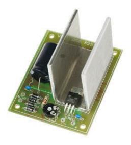
Idoneo per tutti i kit Velleman che richiedono tensioni di alimentazione stabilizzate comprese tra 5 e 14 VDC, e correnti non superiori a 1 A.
