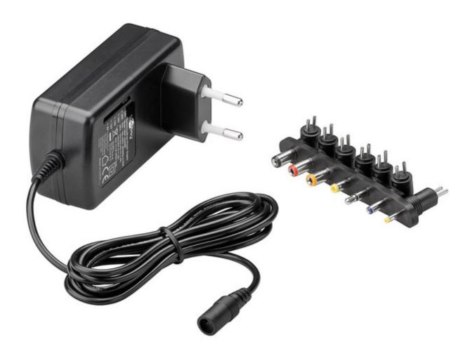
Compatto alimentatore switching da 24 W con tensione di uscita selezionabile da 9 a 24 Vdc (max.1,5 A). Dispone di protezione da cortocircuito, surriscaldamento e sovracorrente. Uscita stabilizzata e basso ripple. Alta efficienza e basso consumo energetico. Completo di 7 differenti adattatori di uscita intercambiabili.
