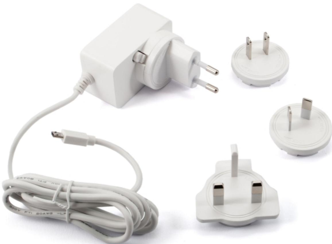
Alimentatore switching con uscita 5 Vdc - 2,5 A, quattro spine intercambiabili (UK, Euro, US e Australia) e cavo con connettore micro USB. È particolarmente indicato per Raspberry Pi 3 tipo B e per una vasta gamma di dispositivi come telefoni cellulari, lettori multimediali, iPhone®, iPad®, iPad® mini, Samsung® Galaxy tab, tablet PC, lettori multimediali, dispositivi di gioco portatili, GPS, ecc.
