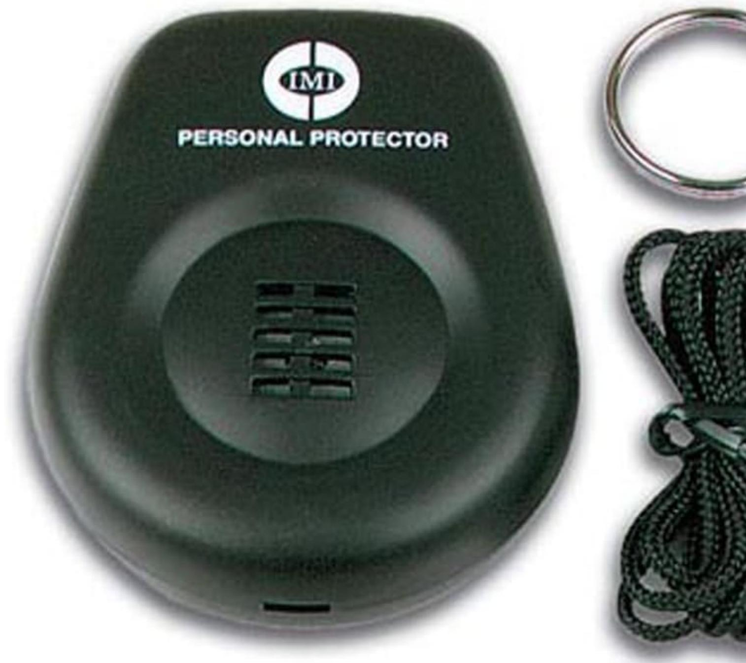
Allarme antiscippo a batterie dotato di sirena piezo da 110 dB. Il suo funzionamento è estremamente semplice: la linguetta in plastica, posta a capo del cordino (in dotazione) ed inserita nella fessura presente sul dispositivo, disabilita l'allarme acustico; quest'ultimo si attiva solamente a seguito di uno strappo che provoca la fuoriuscita della linguetta dalla propria sede. Può essere utilizzato per proteggere dal furto borse, ventiquattrore, notebook, ecc.
