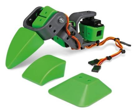
Questo set, una volta montato, permette di realizzare una gamba a tre articolazioni. Può essere utilizzato come parte di ricambio per il robot bipede, quadrupede (vedere correlati) oppure per realizzare un proprio robot. La confezione comprende tutte le parti plastiche, tre mini servo RC, tre differenti forme di piedi, viti, dadi e fascette.
