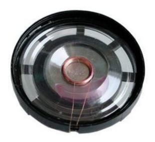
Altoparlante in miniatura da 0,28 watt con impedenza 8 ohm, diametro 29 mm, spessore circa 9 mm.
