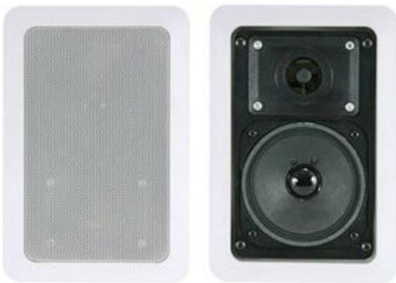
Altoparlante da incasso a 2 vie con impedenza 8 ohm. Woofer: 4" paper cone, tweeter: 1/2" mylar dome, power line 100 V / 8 Ohm: 6 W, risposta in frequenza: 150 Hz ~ 15.000 Hz , sensibilità: 89dB @ 1W / 1m, dimensioni: 150 x 220 x 90 mm, dimensioni foro da incasso: 125 x 190 mm, peso: 1,2 kg. Colore: bianco.
