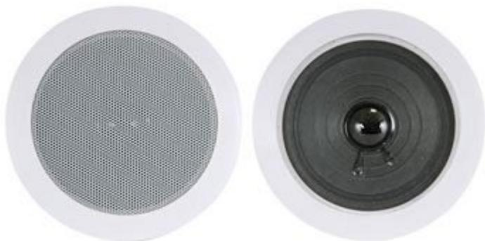
Altoparlante da incasso con impedenza 8 ohm. Woofer: 4" paper cone, power line 100 V / 8 Ohm: 6 W, risposta in frequenza: 150 Hz ~ 15.000 Hz , sensibilità: 90dB @ 1W / 1m, dimensioni: 135 (diametro cornice) x 81mm (profondità), dimensioni foro da incasso: Ø 120 mm, peso: 0,6 kg. Colore: bianco.
